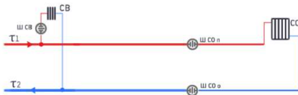
Рисунок 4 - Схема подключения потребителей к двухтрубной тепловой сети (при наличии внутридомовой системы отопления), зависимое присоединение, без смешения
